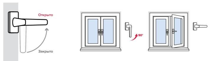
Оконные блоки из ПВХ-профиля оборудованы поворотно-откидным устройством с функцией щелевого проветривания, которое управляется единой ручкой.
