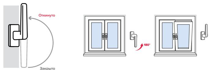
Для перевода створки из закрытого положение в откидное (поворот створки относительно нижней горизонтальной оси, положение «Откинуто») ручку поворачивают вертикально на 180 градусов вверх, затем, потянув за ручку, поворачивают створку относительно нижней горизонтальной оси на заданный изготовителем угол (не более 10 градусов) (откидной режим).
